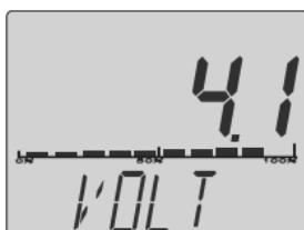
Zeigt die Akkumulator-Spannung und den Ladestand an. 3,2 Volt steht für einen leeren Akkumulator, 4,2 Volt für einen voll aufgeladenen.
