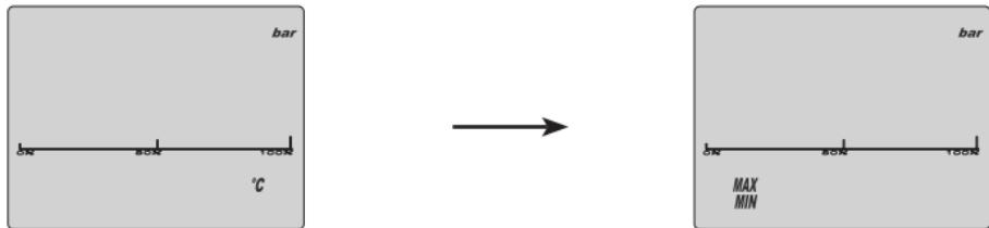
Wechselt zwischen der Temperatur-Anzeige und der Min./Max. Druck-Anzeige.
